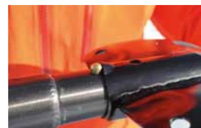
Sogenannte „feed hopper“ ermöglichen das Einstecken der Stiele, ohne die Druckknöpfe zu drücken. Das ist besonders mit Handschuhen angenehm.
