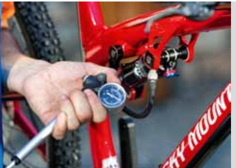
Feinjustage: exakte Einstellung der Hinterbaufederung per Dämpferpumpe.
