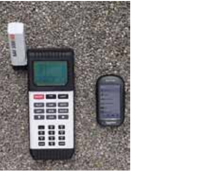
Die Entwicklung der GPS-Geräte: Das alte Gerät (unten) hatte kaum Funktionen und hatte maximal zu fünf Satelliten Empfang. Die neuen Geräte haben viel mehr Funktionen und sind deutlich genauer.
