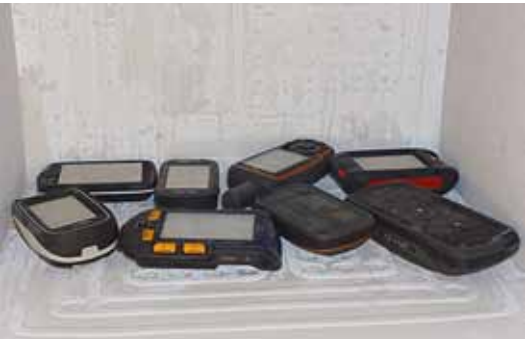
Die Funktionsprüfung im Gefrierschrank haben die Testmodelle bestanden. Natürlich sind dann die Batterielaufzeiten kürzer. Wir haben auch geprüft, wie spritzwassergeschützt und dicht die Geräte sind.
