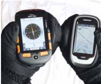
Mit Handschuhen lassen sich Geräte mit Tasten (Garmin 64s, Satmap) besser bedienen als solche mit Touch-Display. Wer sein Gerät viel im Winter nutzen möchte, sollte das bedenken.
